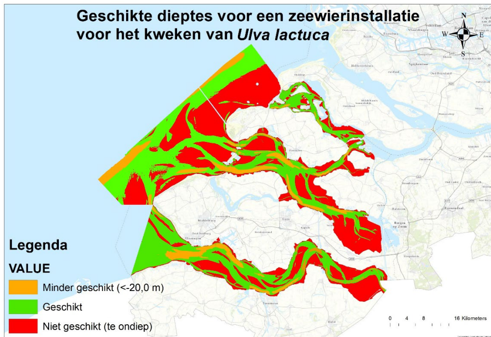
Figuur 13 – Geschikte locaties voor het kweken van Ulva lactuca op basis van geschikte dieptes voor een zeewierinstallatie
