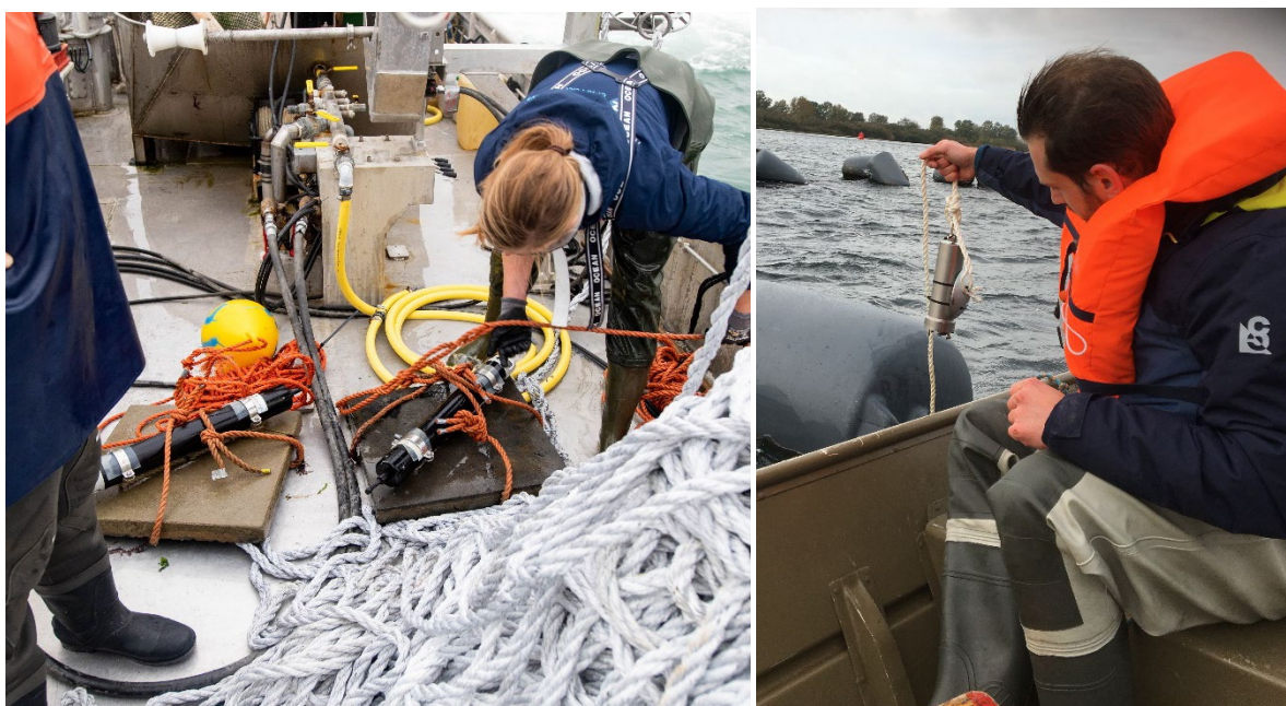
Figuur 2. Gebruikte sensoren binnen project ZEEMOS. Voor het meten van stroomrichting en snelheid (links) en chlorofyl-a (rechts). (Foto's: Lisette Rabenberg en Sanne Schellekens)
